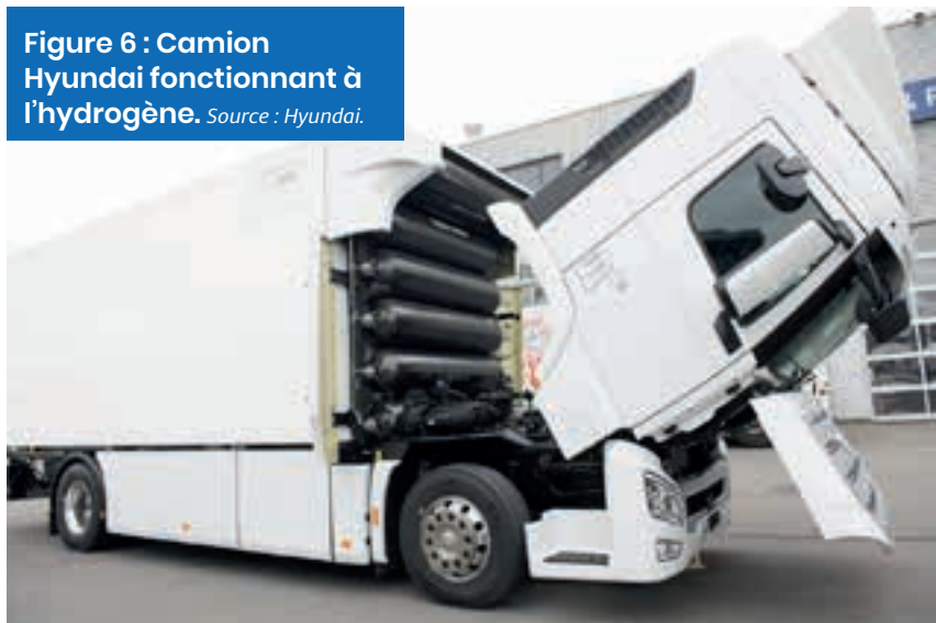
Figure 7 : Les sept bonbonnes d'hydrogène fixées à l'arrière de la cabine des camions Hyundai contiennent 34 kg d'hydrogène. Source : Hyundai.
