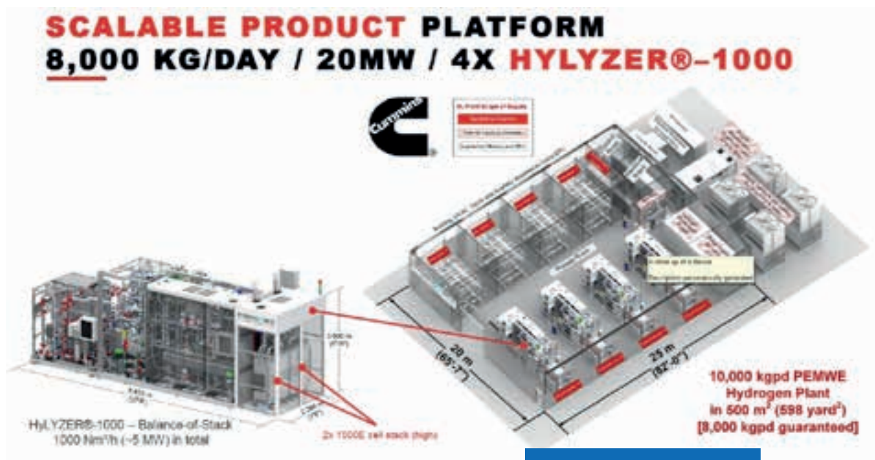
Figure 21 : Exemple d'installation de production 20 MW.
