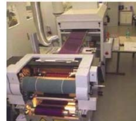
Silicium amorphe sur plastique (Flexcell)
