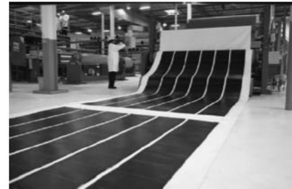
Silicium amorphe sur inox (Unisolar)
