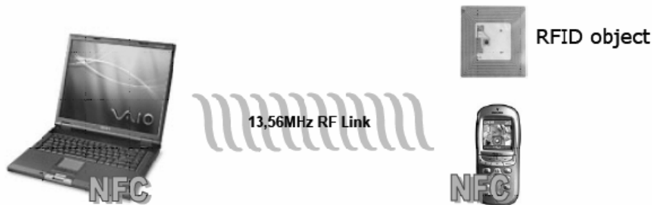
Figure 8 : Etablissement d'une session de communication entre un PC et d'autres dispositifs électroniques grâce au système NFC.
